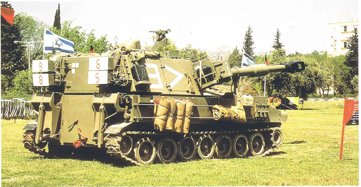
(Oben) Die M109A2 ist ein sehr massiv aussehendes Gerät, was hier durch die Vielzahl der außen mitgeführten Ausrüstungsteile noch unterstrichen wird. Die schwarzen und roten Erkennungstafeln an der Vorderseite der Selbstfahrlafette sowie die hinten angebrachte Flagge gehören zu den Erkennungszeichen aller israelischen Artillerieeinheiten.
