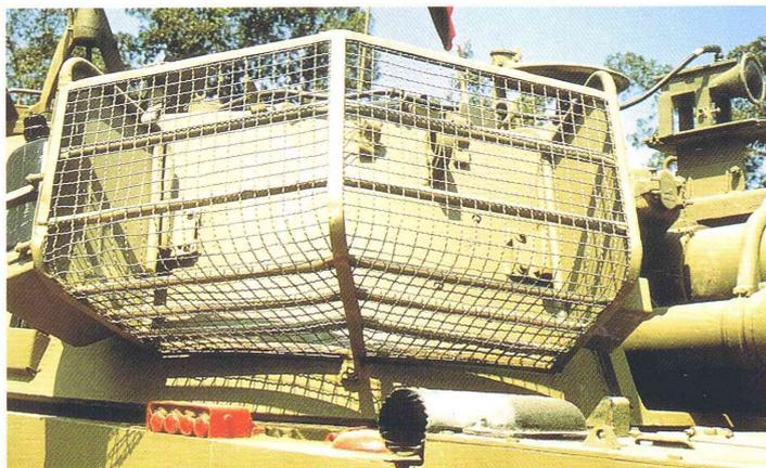
(Links) Ein sehr eigenwilliges Erkennungsmerkmal der israelischen M109 sind die in Israel angefertigten Staukörper, eine Kombination aus Metall-profilen und -rohren sowie Maschendraht.
