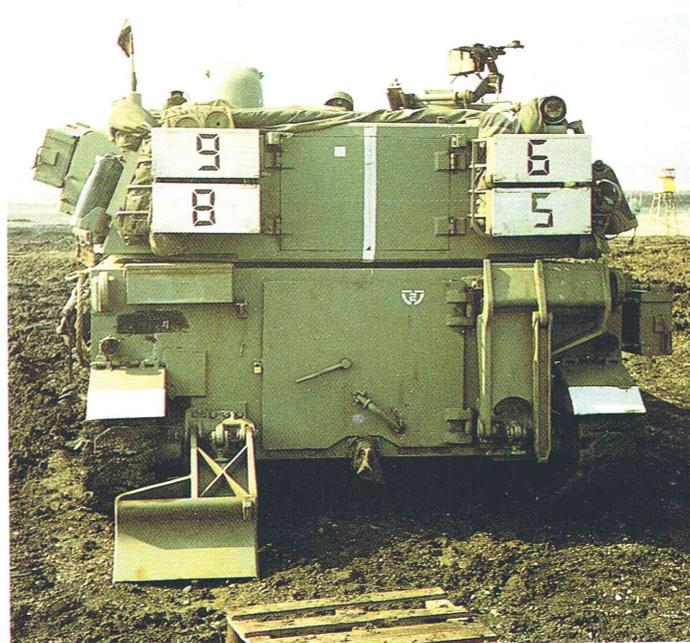
(Links) Eine Gesamtansicht der Rückseite einer M109A2. An den hinteren Turmstaukästen wurden zusätzliche Staukästen angebracht, wie auch in dem freien Raum genau über den hochgeklappten Erdspornen. Bei der M109A2 fällt auch das Fehlen des hinteren Turmüberhangs auf. Die Fotos zeigen außerdem einen der Erdsporne abgesenkt, aber nicht eingegraben, während der andere hochgeklappt ist.
