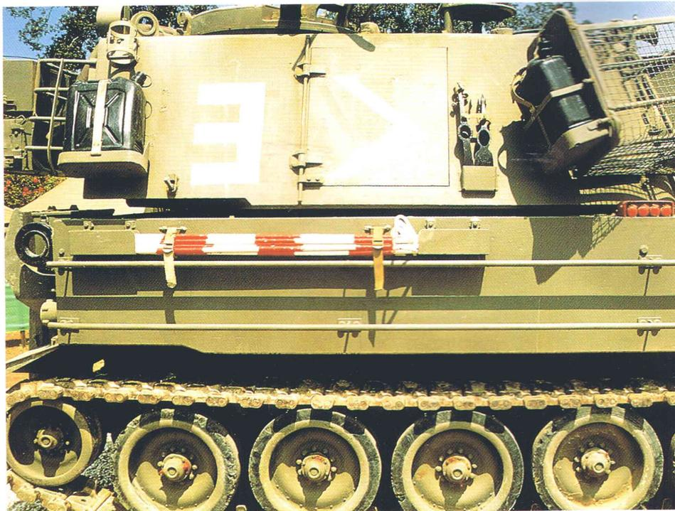
(Oben) Der hintere Teil der rechten Wannenseite. Stauleisten (zur Anbringung von Sturmgepäck, Zeltplanen, Kampftaschen usw.) laufen an beiden Wannenseiten entlang. Genau darüber an der hinteren Wannenpartie angebracht befinden sich die rot-weiß bemalten Richtstangen. An der Rückseite des vorderen Turmkorbs ist eine Halterung für einen großen Kanister, der mit Trinkwasser gefüllt ist. Man beachte die beiden vor der Kommandantenluke angebrachten Spitzhacken.
